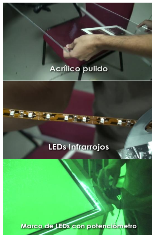
Ilustración 61. Tiras de LEDs IR en el canto del acrílico pulido.
