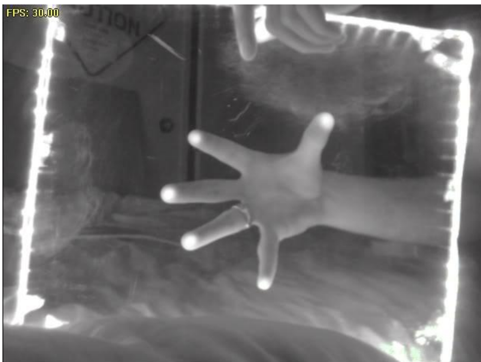
Ilustración 56. Captura de cámara IR, mostrando los blobs generados por FTIR.
